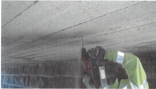
Obr. 5 Deštruktívne určovanie parametrov výstuže
