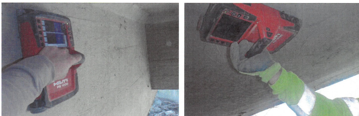
Obr. 4 Nedeštruktívne určovanie polohy výstuže prístrojom CPR Radar PS 1000 X-Scan
