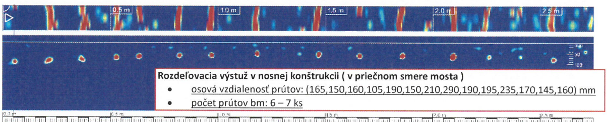
Obr. 20 Rozdeľovacia výstuž v nosnej konštrukcii
